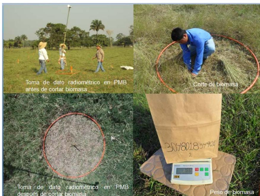
**Figura 4.7. Proceso de medición de reflectancia, colecta y pesado de forraje en los puntos de muestreo de biomasa.**
