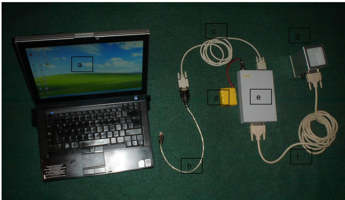
**Figura 4.6. Equipo de muestreo: a) Lap Top/PC, b) Cable convertidor de serial a USB(Manhatan), c) Cable serial machihembra, d) Baterías, e) Datalogger MEX-V1.0, f) Cable Serial Puerto Paralelo, g) Radiómetro CropScan ® .**
