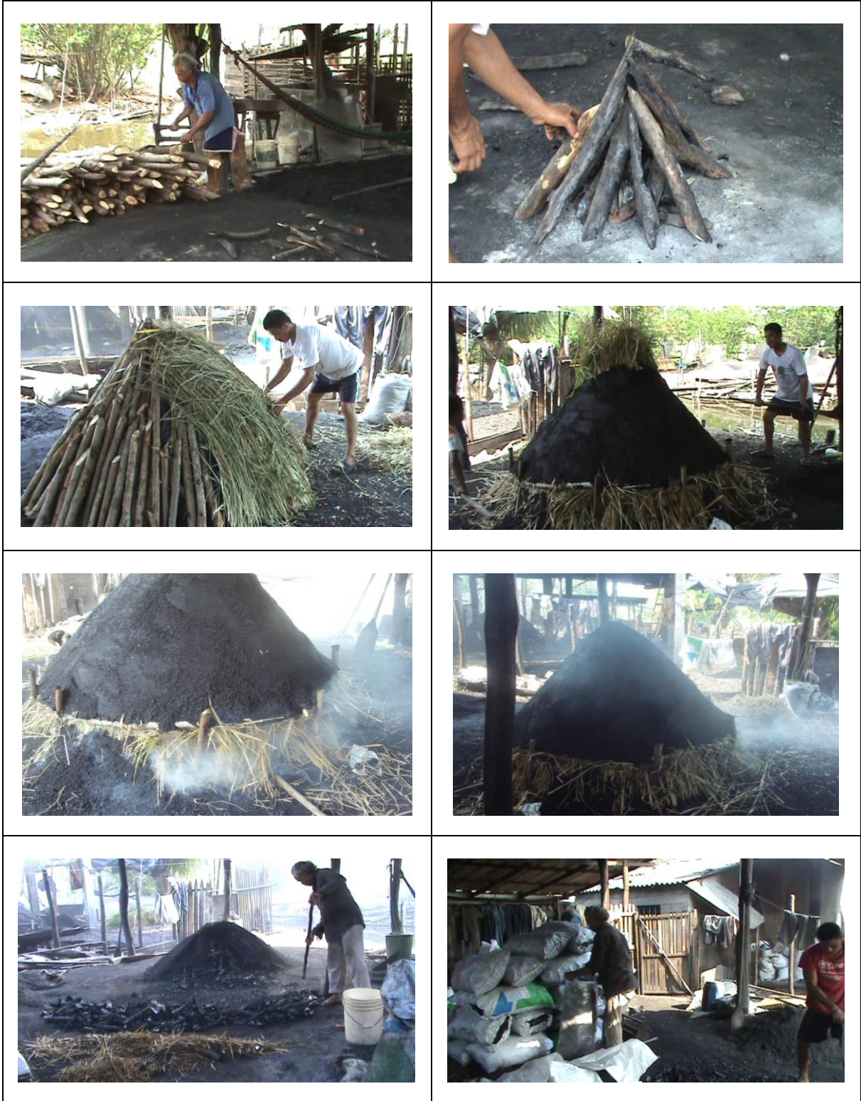
Figura 2. 3 Etapas en la fabricación de las carboneras. Fuente: Elaboración propia con base en observaciones en Moctezuma 1ª sección. COLPOS, 2012.
