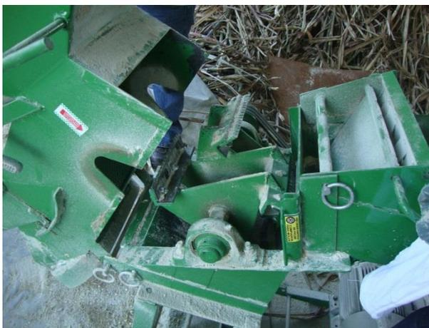
Figura 6. Molino Picadora, utilizado para moler las muestras.
