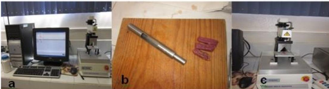
Figura 4. Pruebas de textura en carne: a) Calibración del texturómetro, b) Obtención de la muestra, c) Evaluación de textura en carne.
