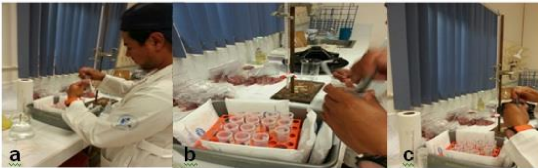
Figura 3. Realización de la técnica de CRA: a) Preparación de la muestra, b) Enfriamiento de la muestra, c) Mezclado de la muestra.
