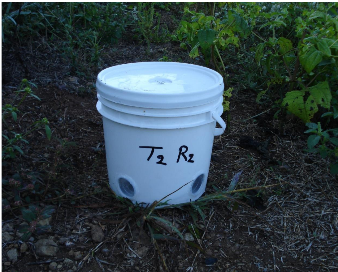
Figura 4. Trampa con orificios circulares y conos internos (TOCCI), usada para la captura del picudo del agave.
