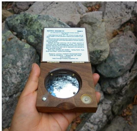
Figura 15. Densitómetro utilizado para medir la espesura de dosel.
