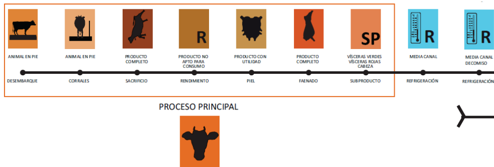
Figura 7. Proceso de producción del rastro Fuente: Guía de buenas prácticas de diseño para establecimientos de sacrificio TIF 1, 2102.
