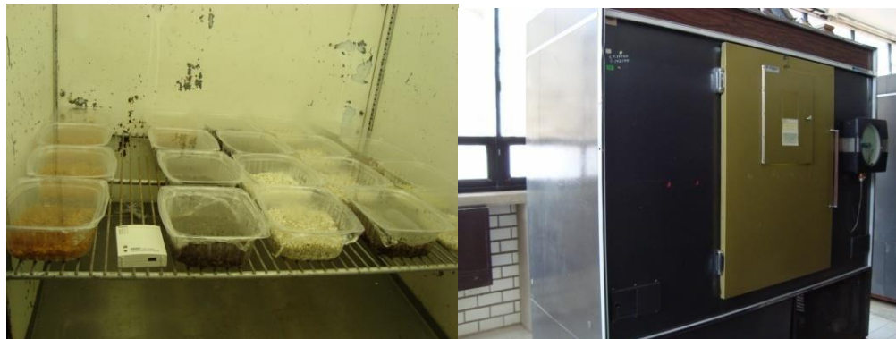
Figura 9. Cámara de ambiente controlado a temperatura de 20 °C (ambiente 1)
