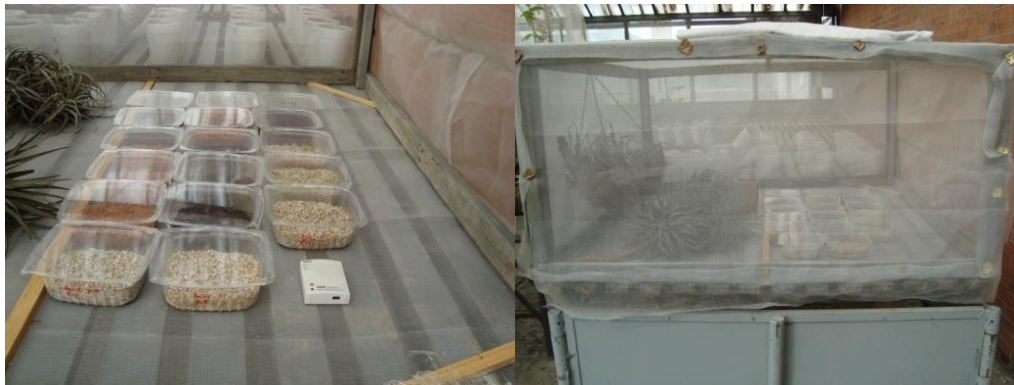
Figura 10. Invernadero a temperatura media mínima 14 °C y máxima 24 °C (ambiente 2)
