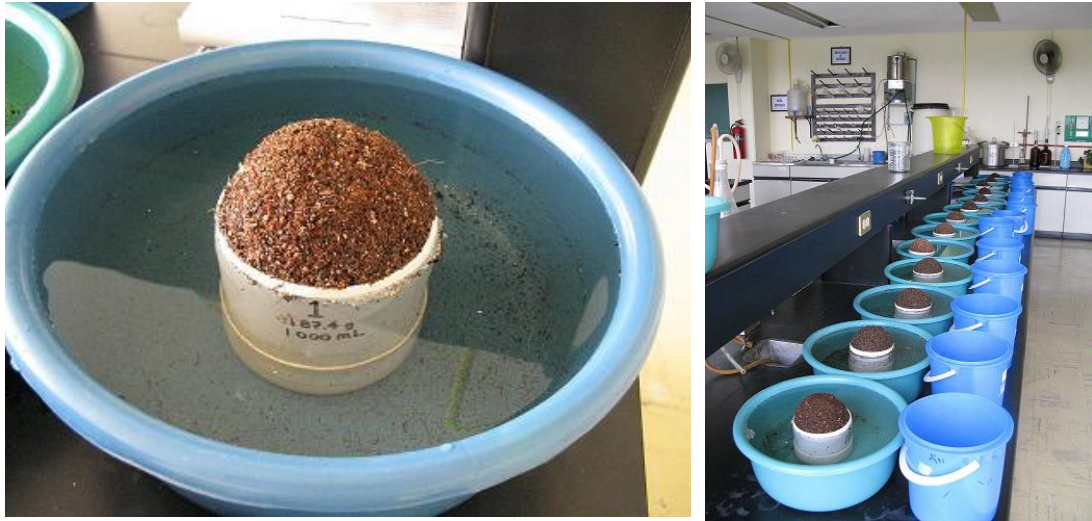
Figura 18. Muestra los porómetros realizados con PVC, para la medición de la retención de humedad, la capacidad de aireación, la porosidad total, la densidad aparente de los sustratos.
