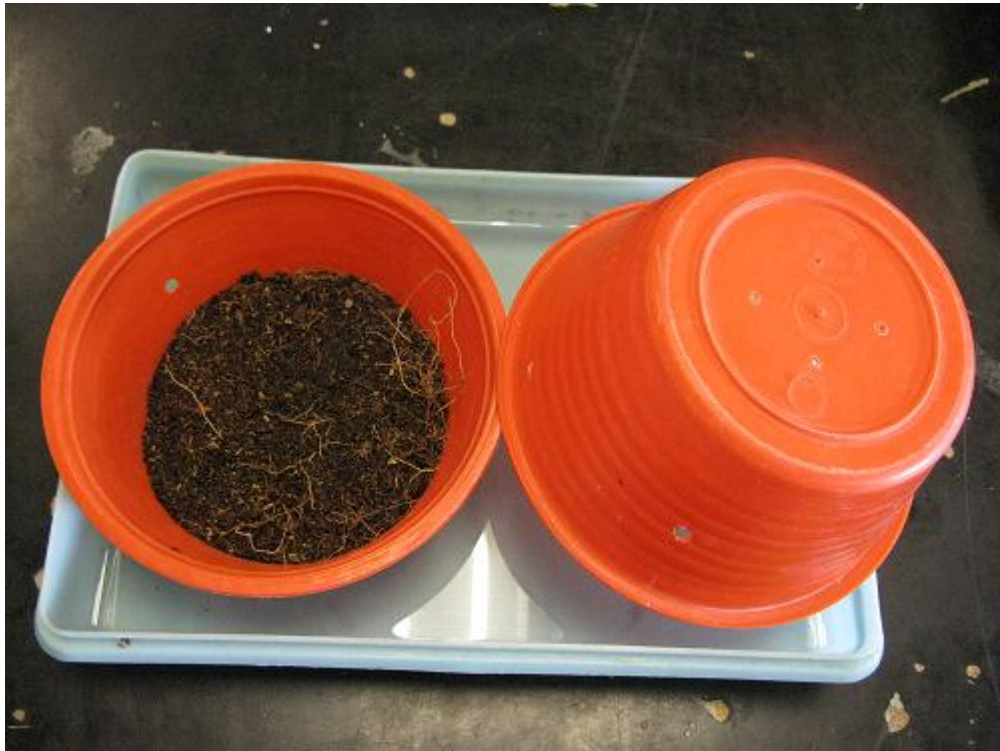
Figura 20. Contenedores para llevar a capacidad de saturación por capilaridad a los sustratos que posteriormente se les realizará la capacidad de retención de humedad.
