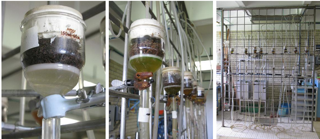
Figura 19. Embudo con filtro de vidrio incluido, para realizar curva de liberación de humedad en sustratos de crecimiento en invernadero.
