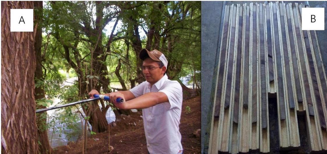
Figura 1.3 (A) Extracción de virutas con un taladro Pressler en ahuehuete (B) Muestras preparadas y colocadas en bases de madera.
