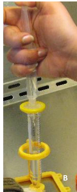
Figura 9. Esterilización de glucosa para el MEM. A) Vaciado de la glucosa diluida en agua en una jeringa para su filtración. B) Filtrado de la glucosa al 4% a través de un filtro MILLEX® de 0.22 \mu\text{m} desechable.
