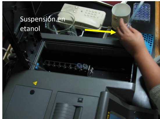
Figura 11. Suspensión de colorante en etanol (96%) a las celdas del espectrofotómetro Spectronic® (Genesys 2).
