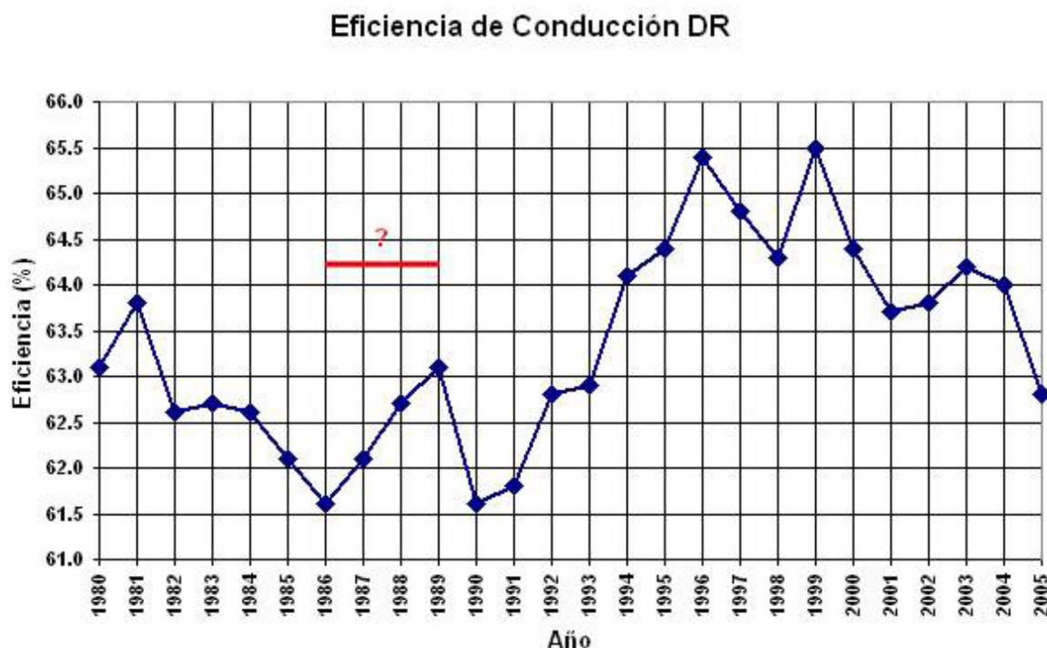
**Figura 4.3. Variaciones de las eficiencias de conducción en los Distritos de Riego**
