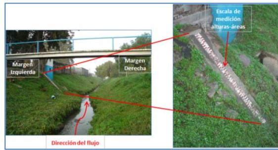
Figura 11. Estación de aforo de la Cuenca del Río Chapingo.
