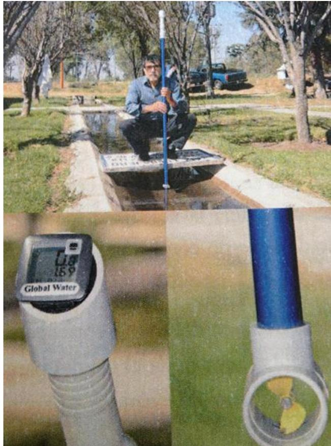
**Figura 3.9.** Molinete electrónico para aforo en canales.
