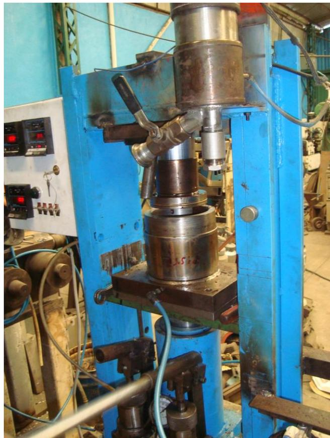
*Figura 9A. El momento que se aplica fuerza sobre la palanca y el vaso inicia movimiento ascendente.*
