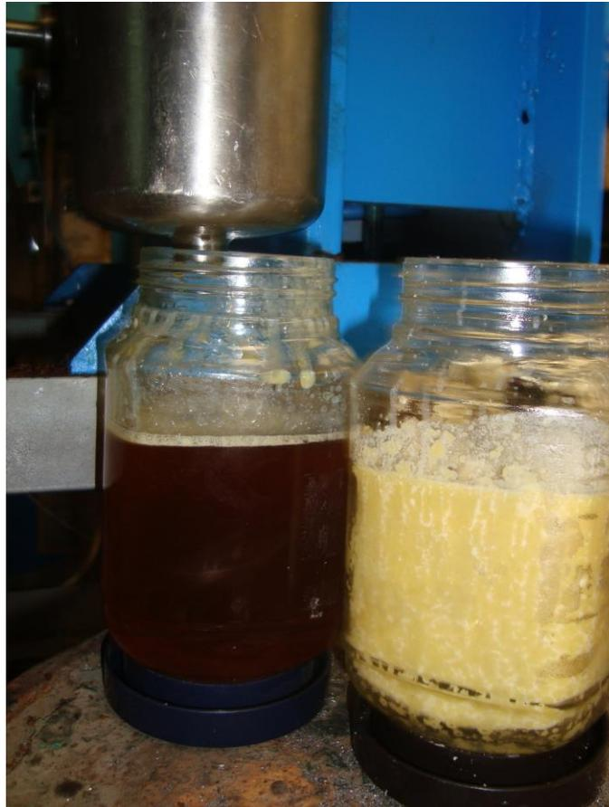
*Figura 11A.* La grasa recién salida del filtro-prensado es líquida, al poco tiempo se solidifica.
