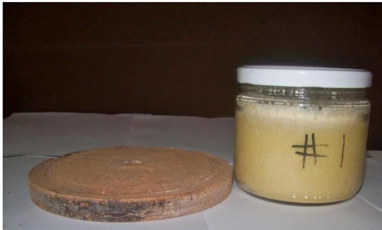
*Figura 1C. Grasa y cocoa de la prueba número 1 (500 kg/cm<sup>2</sup>, 60 min)*
