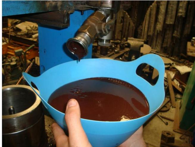
*Figura 6A. El licor de cacao a la salida del tanque agitador*
