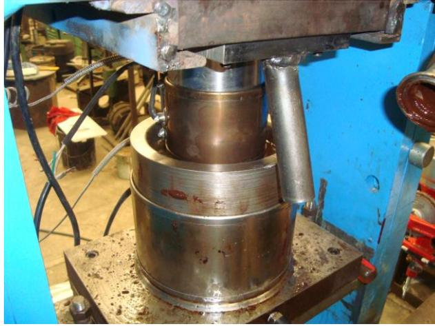
*Figura 8A. El momento que el émbolo superior empieza a ejercer presión al licor de cacao.*
