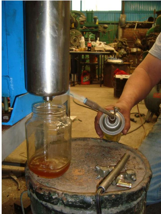
*Figura 10A.* La grasa a la salida del filtro-prensa durante las pruebas preliminares.
