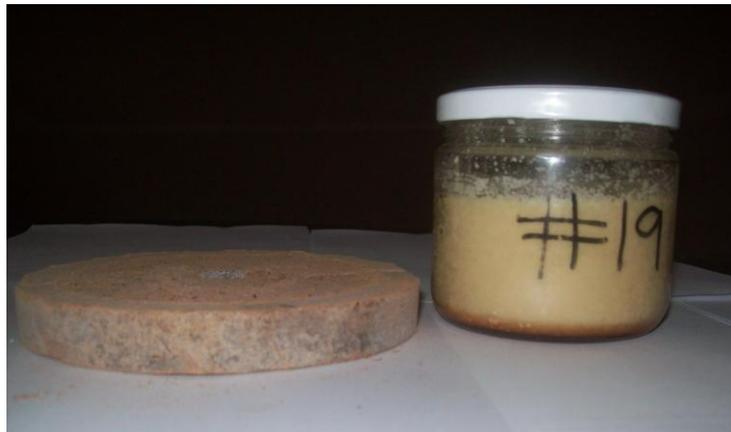
*Figura 4C. Grasa y cocoa de la prueba 19 ( $150 \text{ kg/cm}^2$ , 60 min).*
