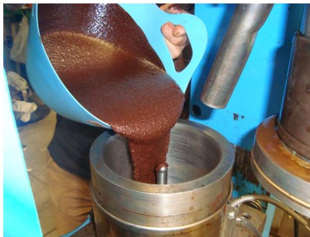
*Figura 7A. El vaso es llenado del cacao agitado durante una prueba preliminar.*
