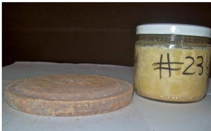
*Figura 2C. Grasa y cocoa de la prueba número 23 (350 kg/cm<sup>2</sup>, 60 min)*
