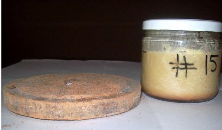
*Figura 3C. Resultado de la prueba número 15 ( $250 \text{ kg/cm}^2$ , 60 min).*
