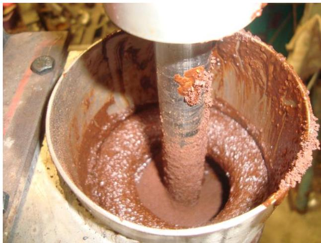
*Figura 5A. El tratamiento térmico mediante el tanque agitador.*
