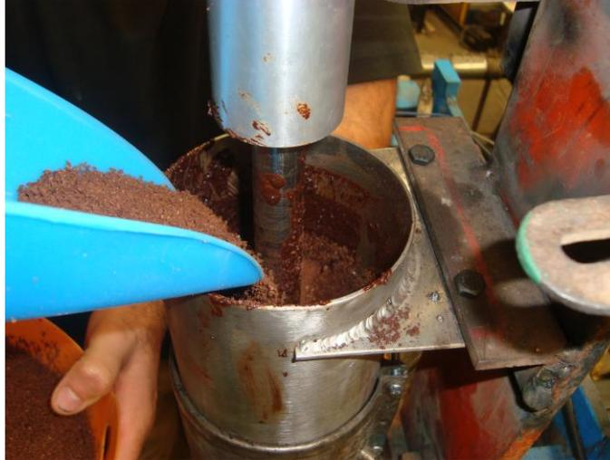
*Figura 4A. El cacao molido a la entrada del tanque agitador*
