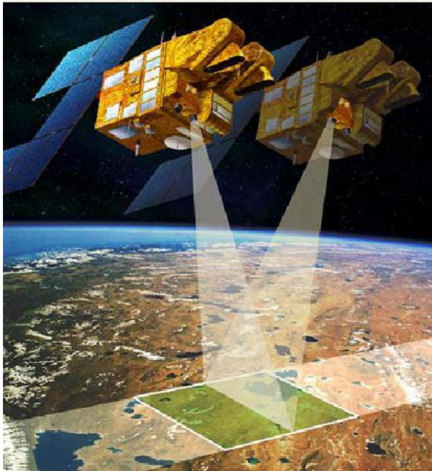
Figura 2.21. Ilustración de un sensor remoto (SPOT 5 VEGETATION) adquiriendo imágenes estereoscópicas de la superficie terrestre mediante el registro de la radiación electromagnética emitida por el sol y reflejada por ella
