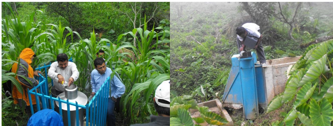
Figura 4.30. Instrumentación de la Nanocuenca Berriozábal con pluviógrafo y aforador tipo H con limnógrafo integrado
