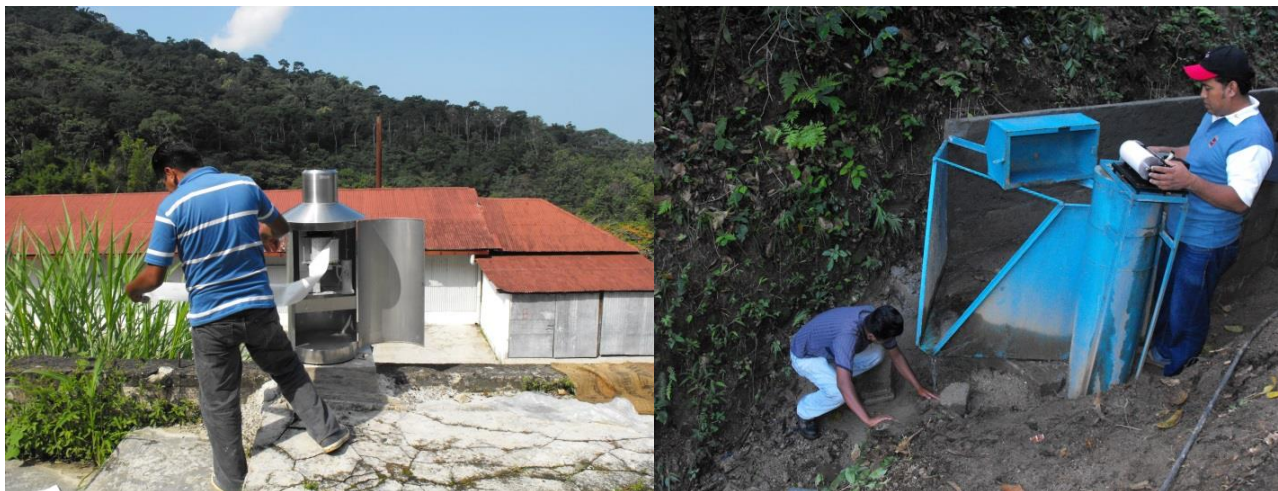
Figura 4.29. Instrumentación de la Nanocuenca Finca Hannover con pluviógrafo y aforador tipo H con limnógrafo integrado
