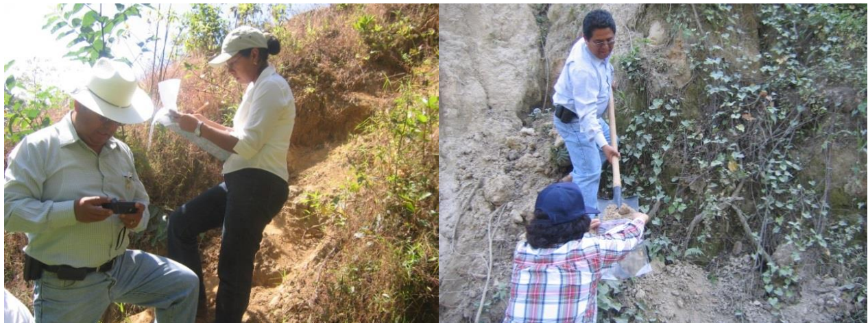
Figura 4.33. Muestreo de los suelos de las cuencas para su caracterización y determinación del factor K de la EUP
