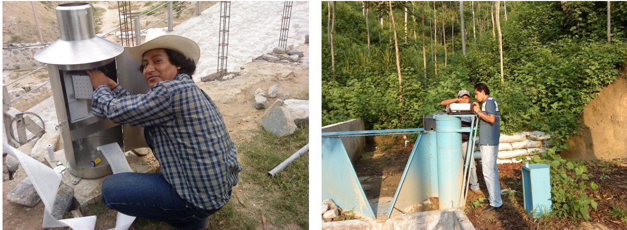
Figura 4.28. Instrumentación de la Nanocuenca Finca Brasil con pluviógrafo y aforador tipo H con limnógrafo integrado
