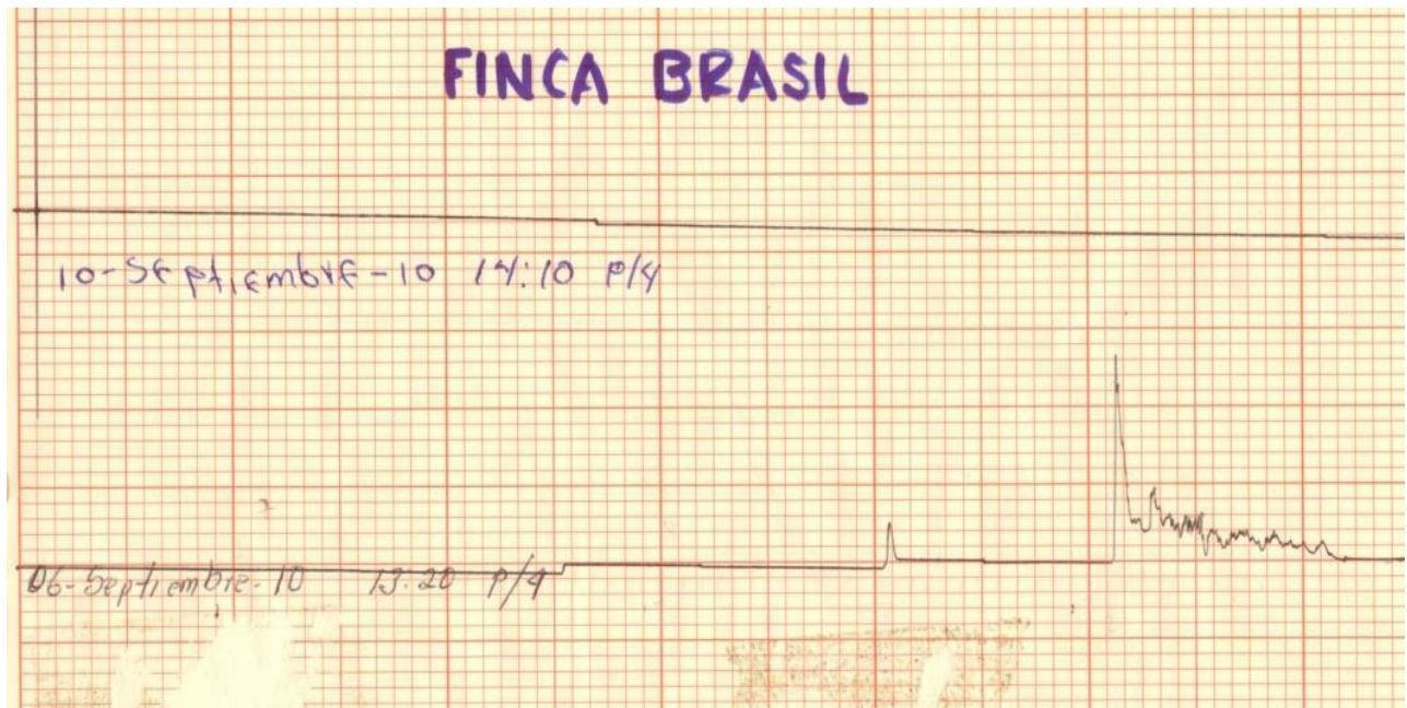
Figura 4.41. Muestra de un limnigrama en la nanocuenca Finca Brasil que se procesó para obtener las láminas escurridas
