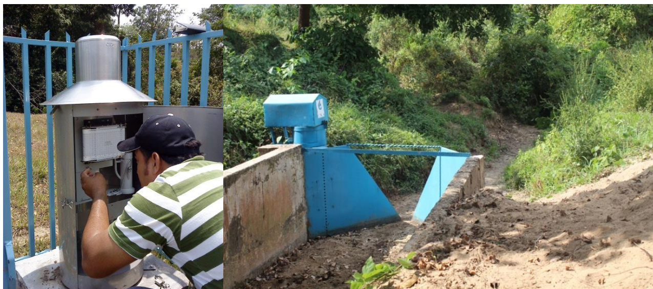
Figura 4.27. Instrumentación de la Nanocuenca Rosita con pluviógrafo y aforador tipo H con limnógrafo integrado
