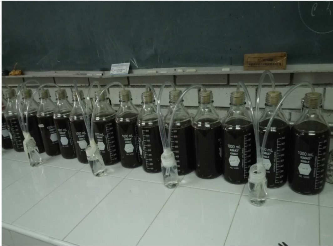
Figura 7. Proceso de fermentación del jugo de caña de azúcar con trampa de agua.
