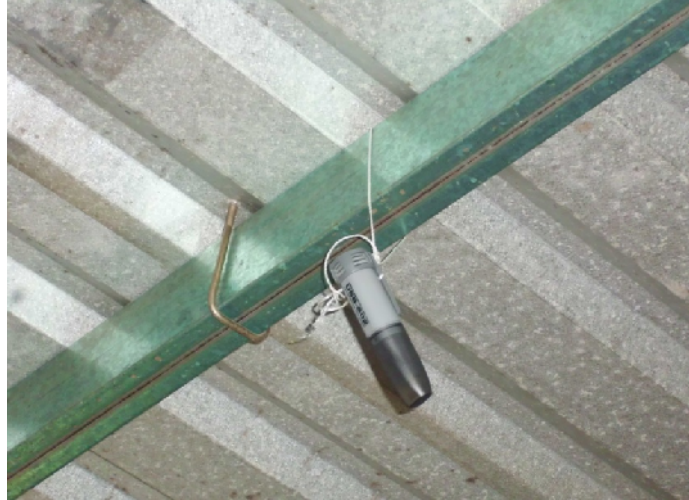
Figura 8. Data logger USB-500 colocado al centro de las habitaciones a una distancia de 15 cm con respecto de la lamina de zinc.
