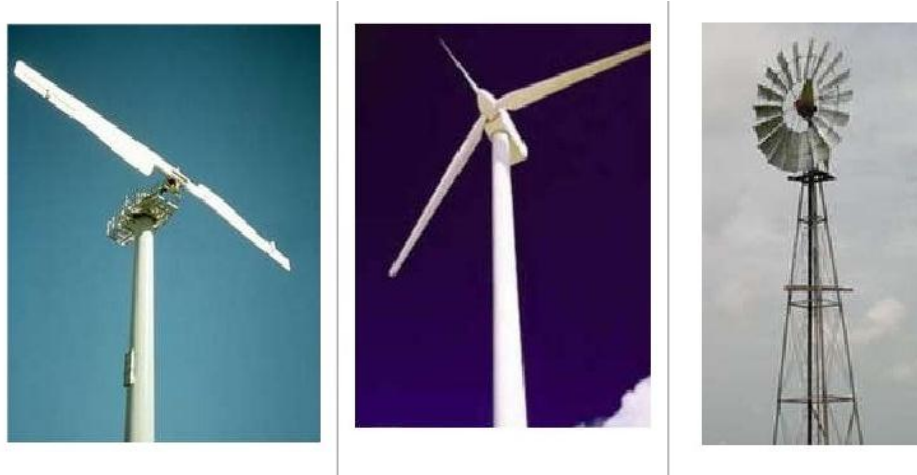
Figura 4.14. Aerogenerador a) bipala, b) tripala y c) multipala.
