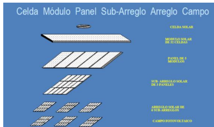
Figura 4.6. Formas de agrupación de los módulos fotovoltaicos.
