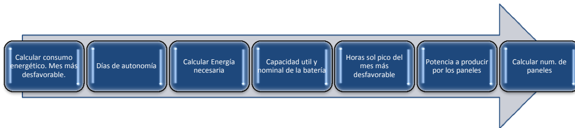
Figura 5.11. Proceso del diseño de la dimensión de un sistema fotovoltaico.
