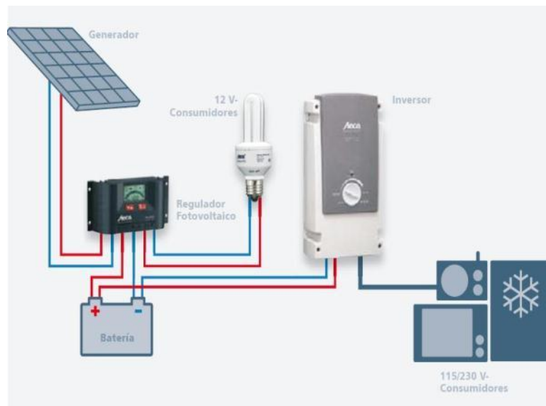
Figura 4.8. Esquema de un sistema fotovoltaico aislado.
