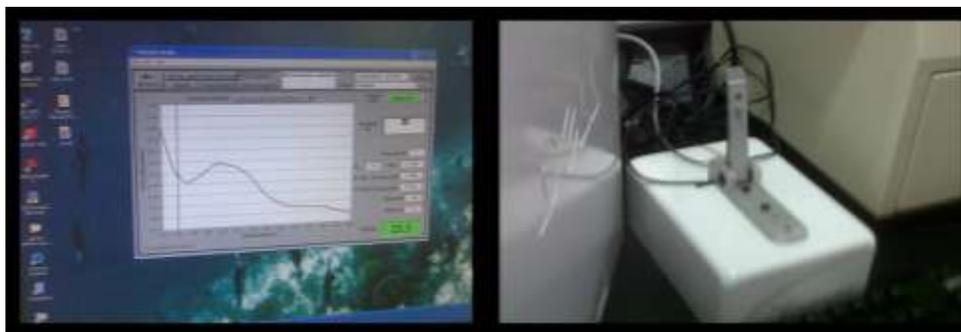
Figura 18. Medición de absorbancia del DNA en las observaciones.
