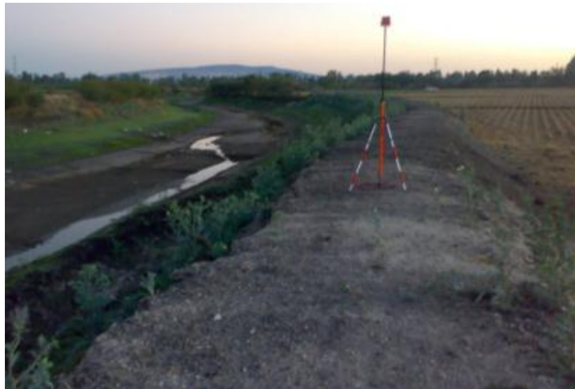
Figura 31. Punto conocido usado para la orientación de la estación.
