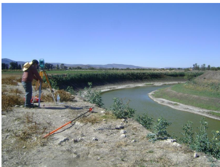
Figura 41. Instalación y nivelación de quipo.
