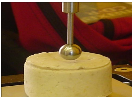
Figura 8. Determinación de la adhesión y cohesión de masa con el TextureAnalyzer TA-XT2.
