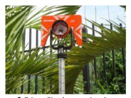
Figura 5. Prisma Simple con tarjeta de puntería.
