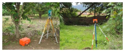
Figura 14. Levantamiento de la zona con Estación total (b)
