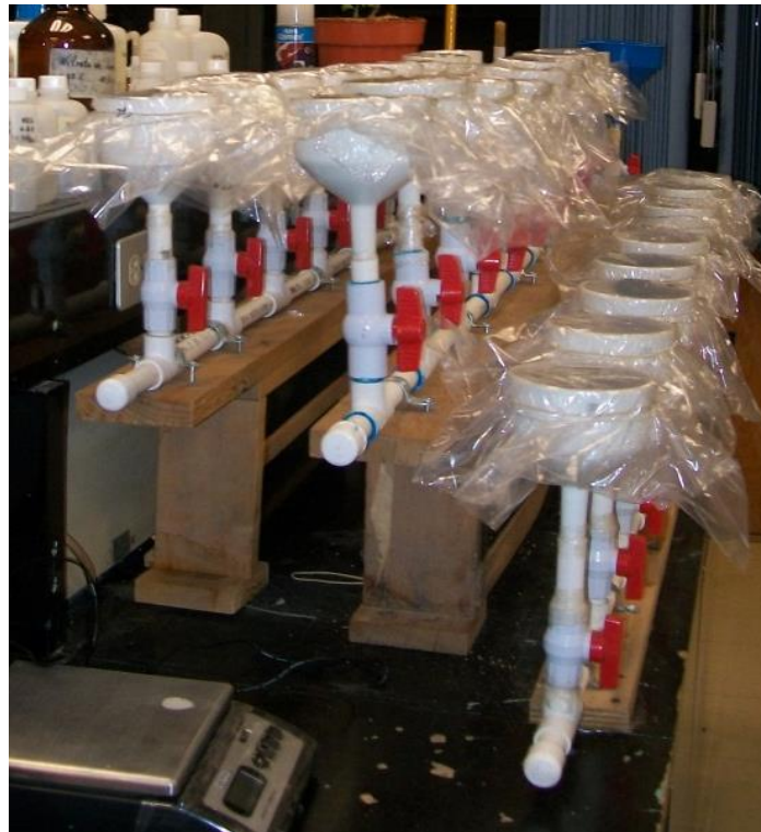
Figura 2.1. Equipo para determinación de la curva de retención de humedad en sustratos que se sometieron a tensiones de 10, 50 y 100 kpa con base en el diseño de Boodt et al. , 1974.
