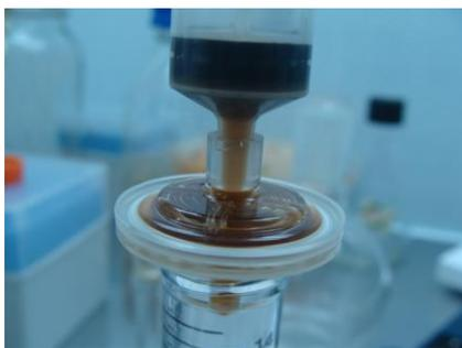
**Figura 6.** Esterilización de los extractos por método de filtración con acrodiscos.
