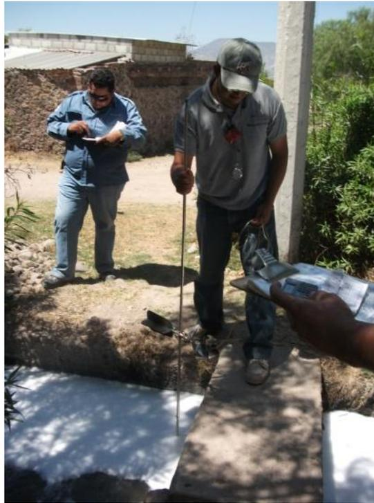
Imagen 8. Aforo de las compuertas con molinete
