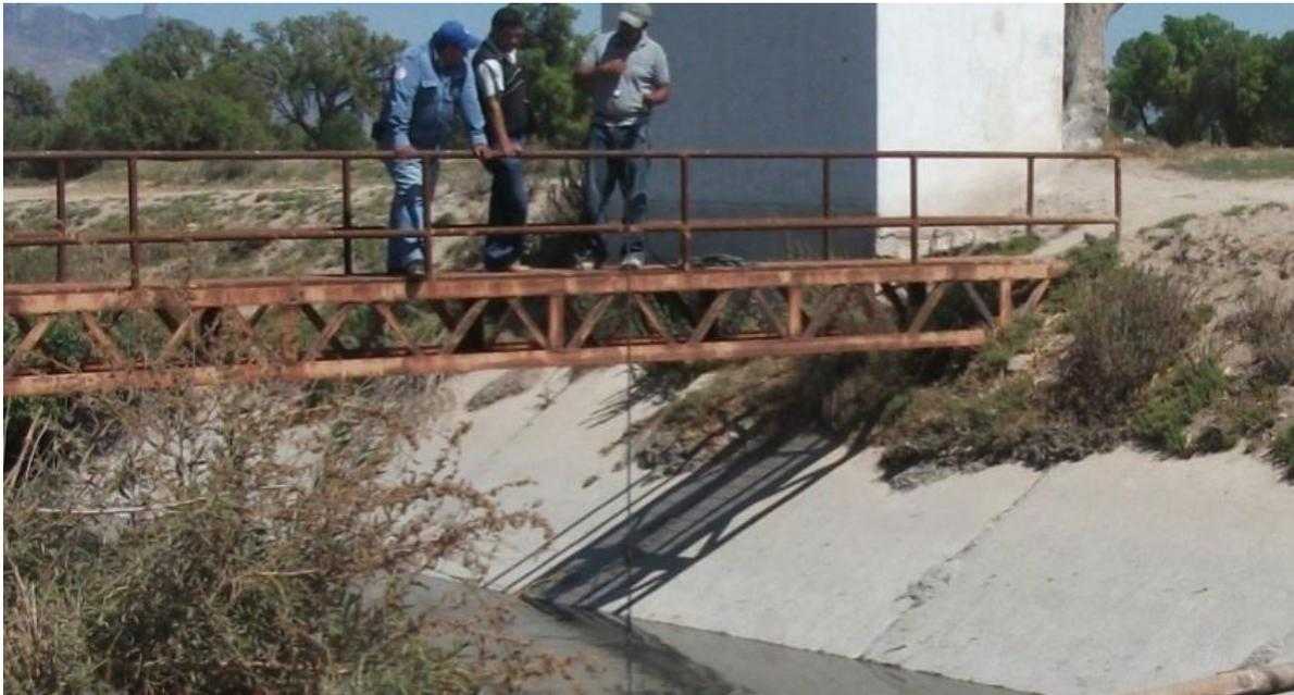
**Imagen 6. Aforo del Canal Principal Requena.**
