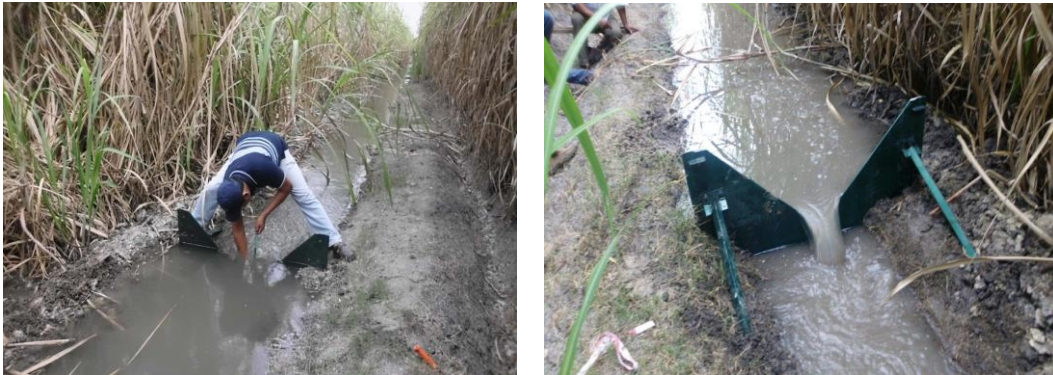
Figura 5. Medición del gasto de agua para el cálculo de la lámina de riego aplicada a cada tratamiento en un experimento de suspensión de riego en el Ingenio Pujiltic, Chiapas, México
