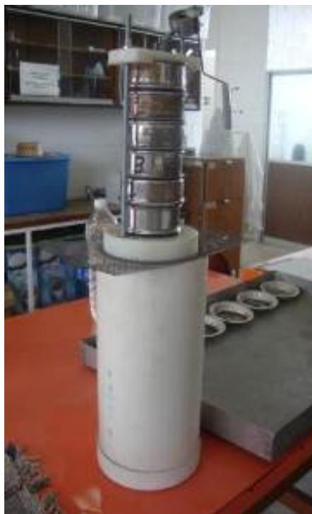
Figura 12. Columna empleada para tamizar los agregados en húmedo
