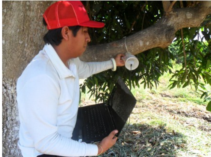
Figura 3. Instalación de data logger para el registro de temperatura y humedad relativa.
