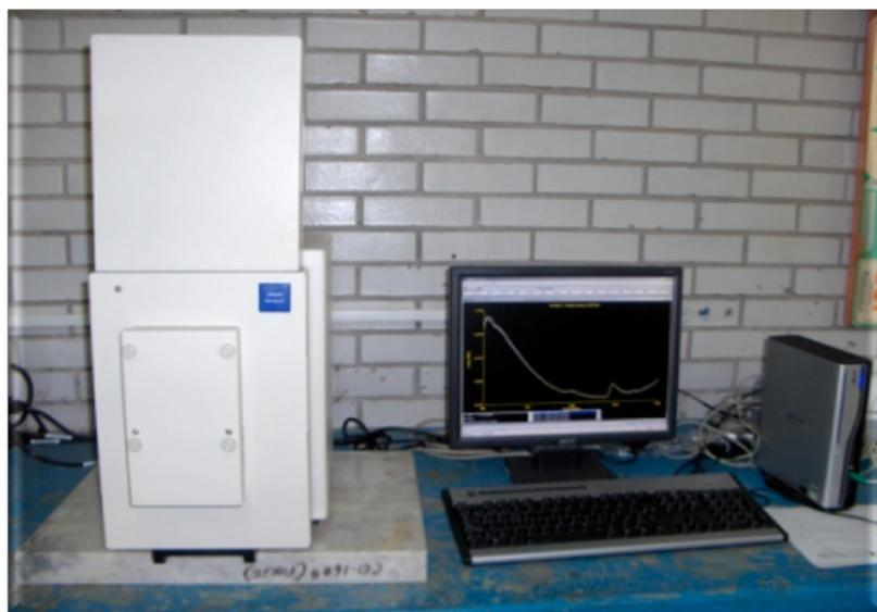
Figura 10. Espectrómetro NIR Versatile Agri Analyzer™ 6500.
