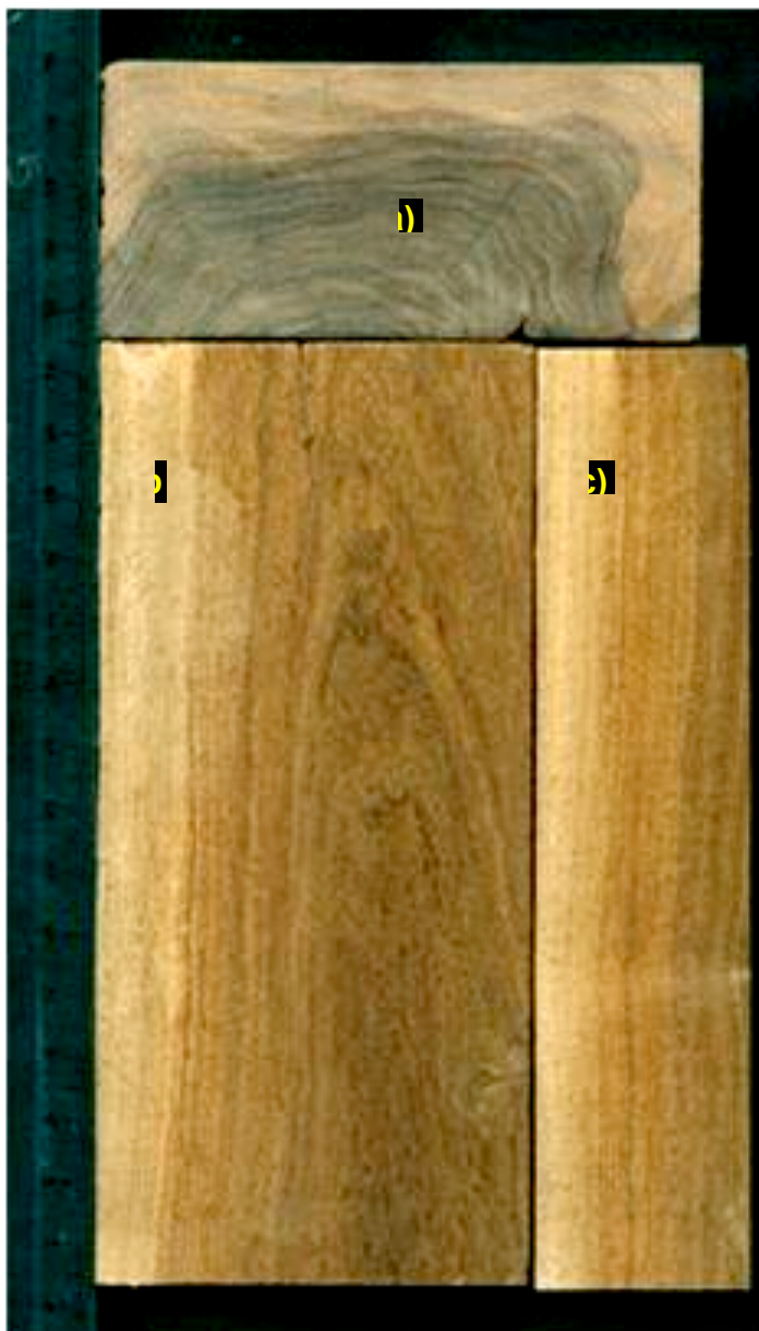
Figura 1. Color, vetado de hilo y textura en cortes típicos de Caesalpinia gaumeri Greenm: a) transversal; b) tangencial y c) radial.
