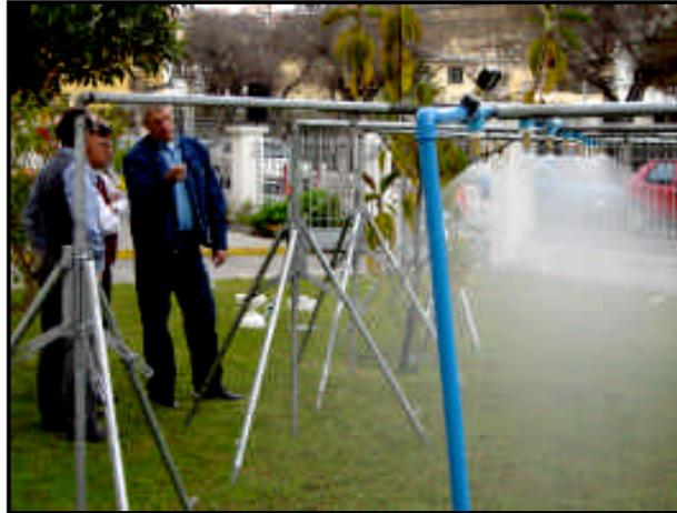
Figura 2.1. Simulador de lluvia utilizado como infiltrómetro en La Serena-Chile, (González, 2004).
