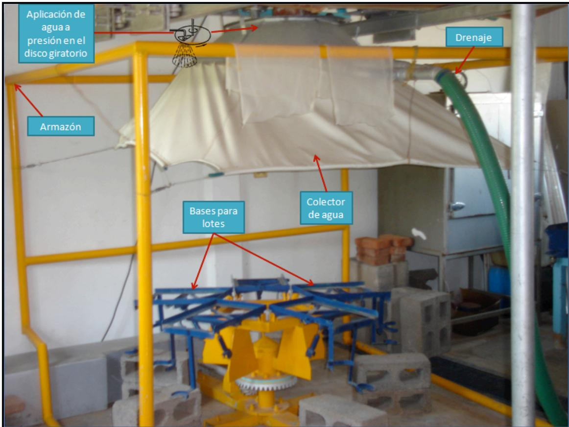
Figura 4.12. Simulador de lluvia con disco giratorio tipo Morin.
