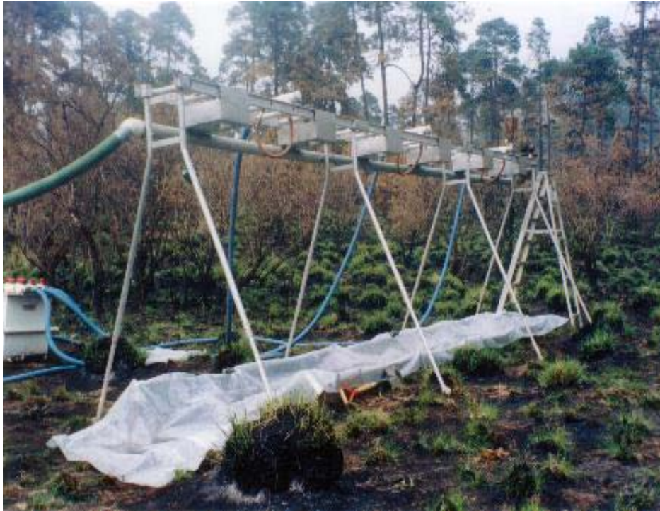
Figura 5.3 Simulador de lluvia automatizado tipo Purdue
