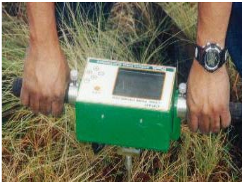
Figura 5.5 Medición de resistencia al penetración en el lote testigo (sin quema)
