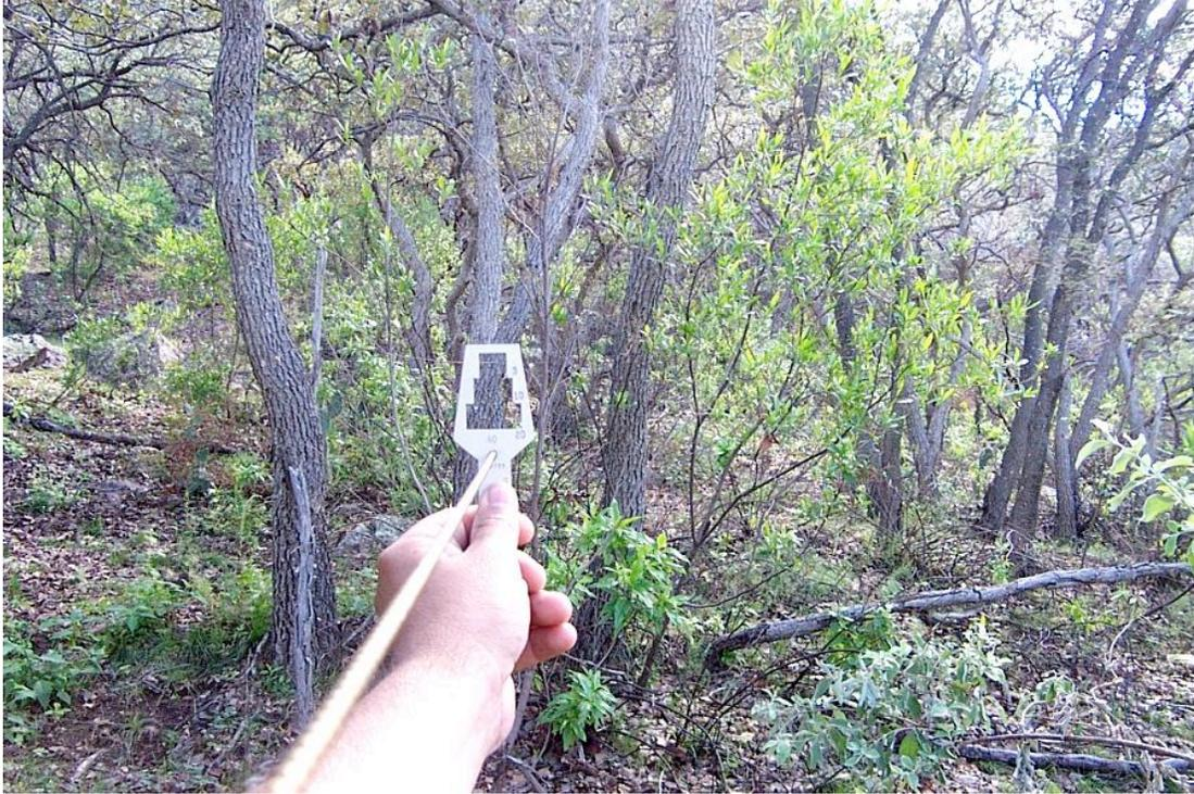
Lámina 3.1. Estimación del área basal del sitio con un dendrómetro Cruz-All ®
