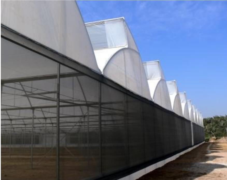
**Figura 4.6..** Estructura de invernadero con ventila cenital
