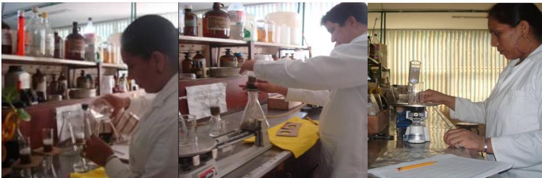
Figura 8. Secuencia de la extracción del nitrógeno mineralizado
