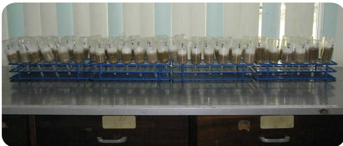
Figura 13. Dispositivos de incubación en el proceso de mineralización de las muestras de abonos orgánicos, método de Stanford y Smith (1972).
