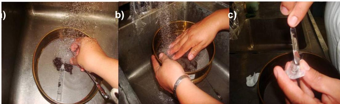
Figura 3. Secuencia para determinación de fibra frotada: a) transferir el residuo de la fibra no frotada al tamiz, b) Lavar bajo corriente frotando el abono y c) cuantificar la fibra frotada.
