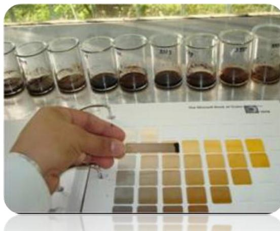
Figuran 10. Determinación del color con pirofosfato de sodio.
