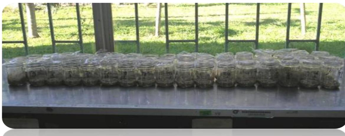
Figura 18. Dispositivos de incubación de nitrógeno mineralizable (Keeney y Bremener, 1967).
