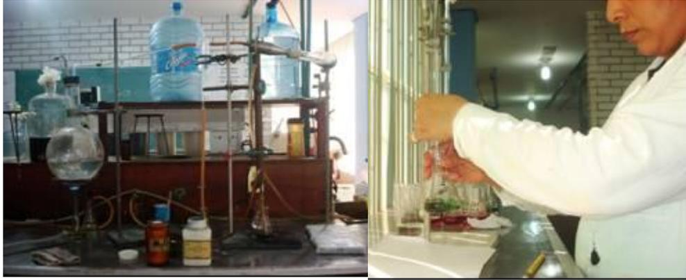
Figura 9. Determinación del nitrógeno inorgánico mediante destilación por arrastre de vapor y su cuantificación por titulación.
