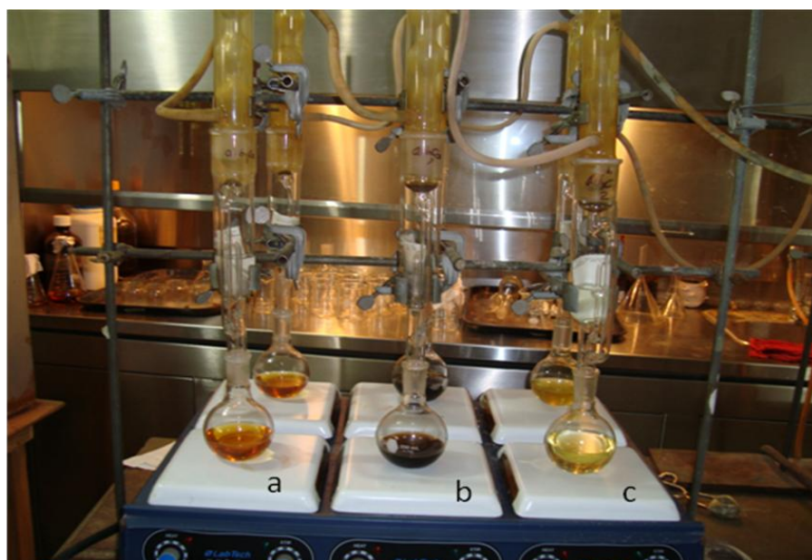
Figura 11. Aspecto de la extracción de hidrocarburos totales del petróleo (HTP) y compuestos derivados del petróleo (CDP) con los disolventes, hexano (a), diclorometano (b) y metanol (c) en un suelo Gleysol.
