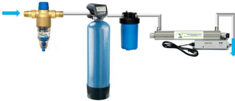
Figura 5.12 Tren de tratamiento de agua con cuatro etapas (Avanty 3/4, CAG 8x40", Filtro BB10x4" y lámpara de desinfección con UV).
