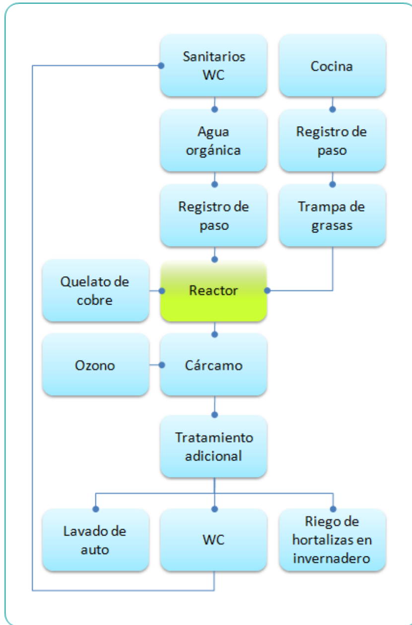
Figura 2.19 Diagrama de flujo del sistema de tratamiento biológico de aguas orgánicas.
