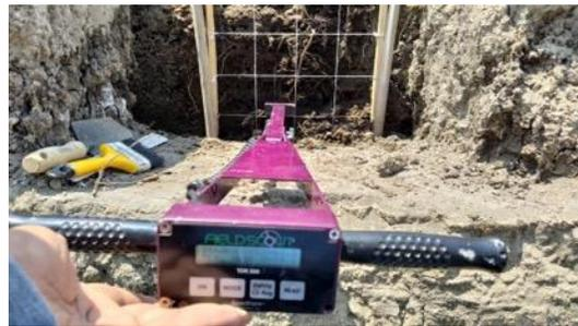
Medición de Contenido volumétrico de humedad
