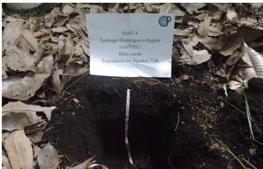
Figura 3. Medida de la profundidad del horizonte A
