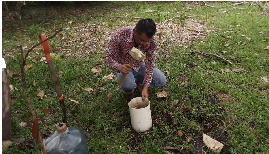
Figura 4. Inserción en el suelo del cilindro
