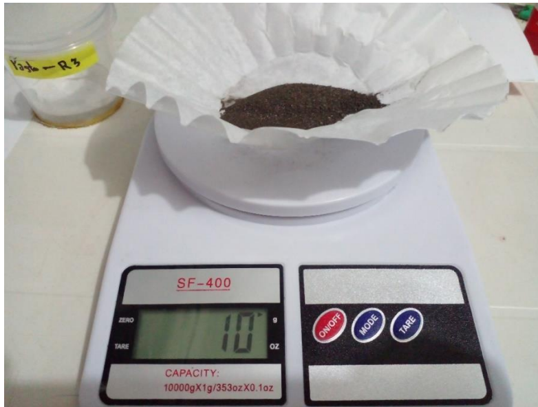
Figura 9. Peso de 10 g de suelo para ensayo de estabilidad de agregados
