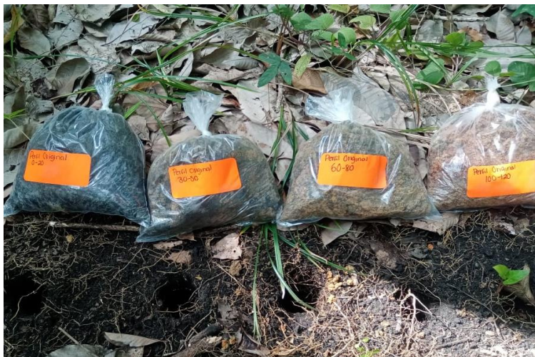
Figura 2. Muestras de suelo de la profundidad muestreada con diferentes usos del suelo, obtenidas con barrena
