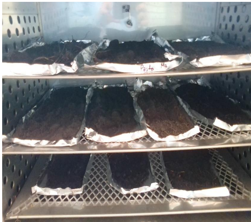
Figura 7. Muestras de suelo secadas a 105 °C durante 24 h
