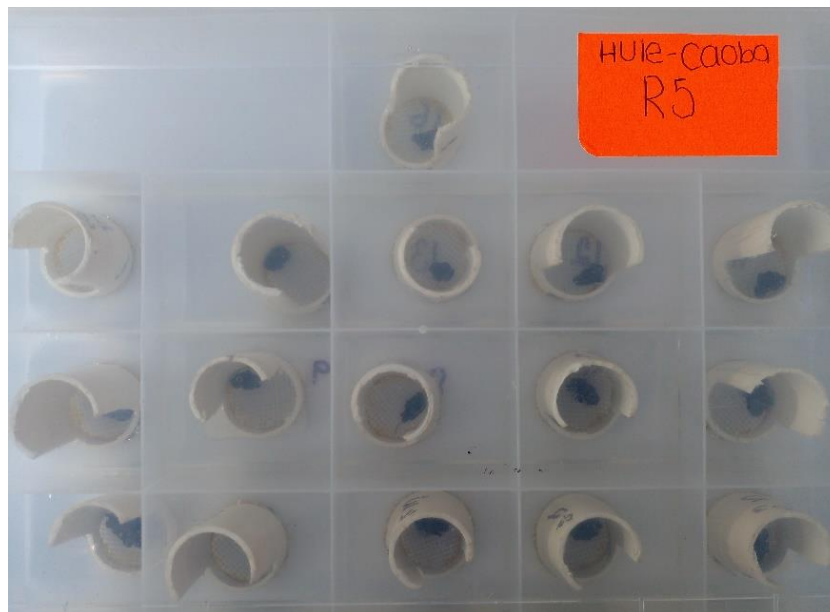
Figura 13. Agregados sumergidos en agua purificada
