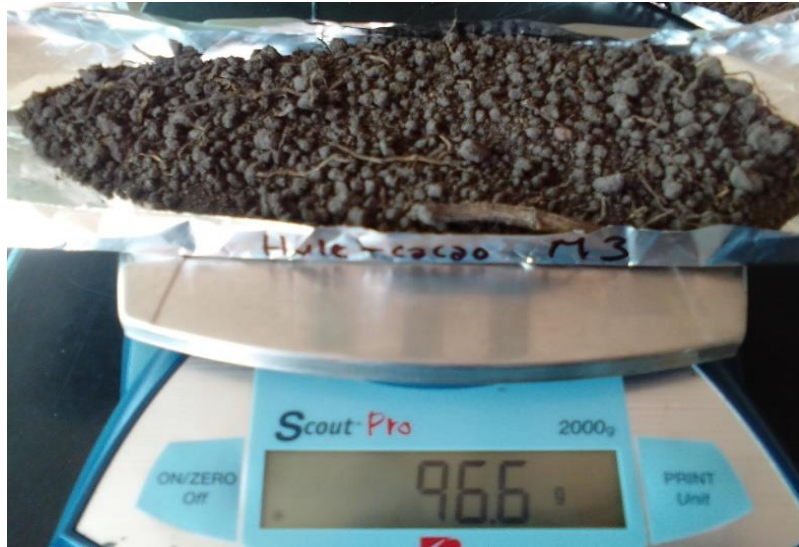
Figura 6. Peso del suelo más el peso del aluminio (peso de masa conocida)
