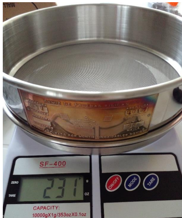
Figura 8. Peso del tamiz de 0.25 mm
