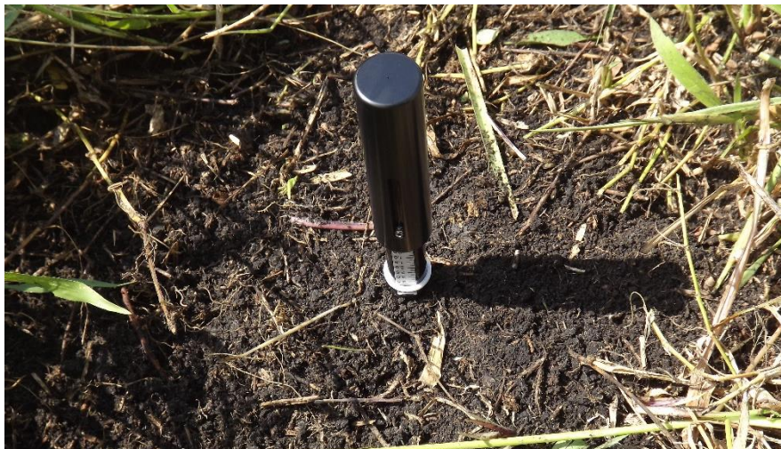
Figura 5. Medición de la resistencia a la penetración (MPa)
