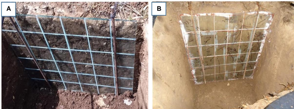
Figura 1.2. A) Placa de vidrio (rizotrón) cuadrículado, B) lámina de acetato puesta sobre la placa de vidrio.
