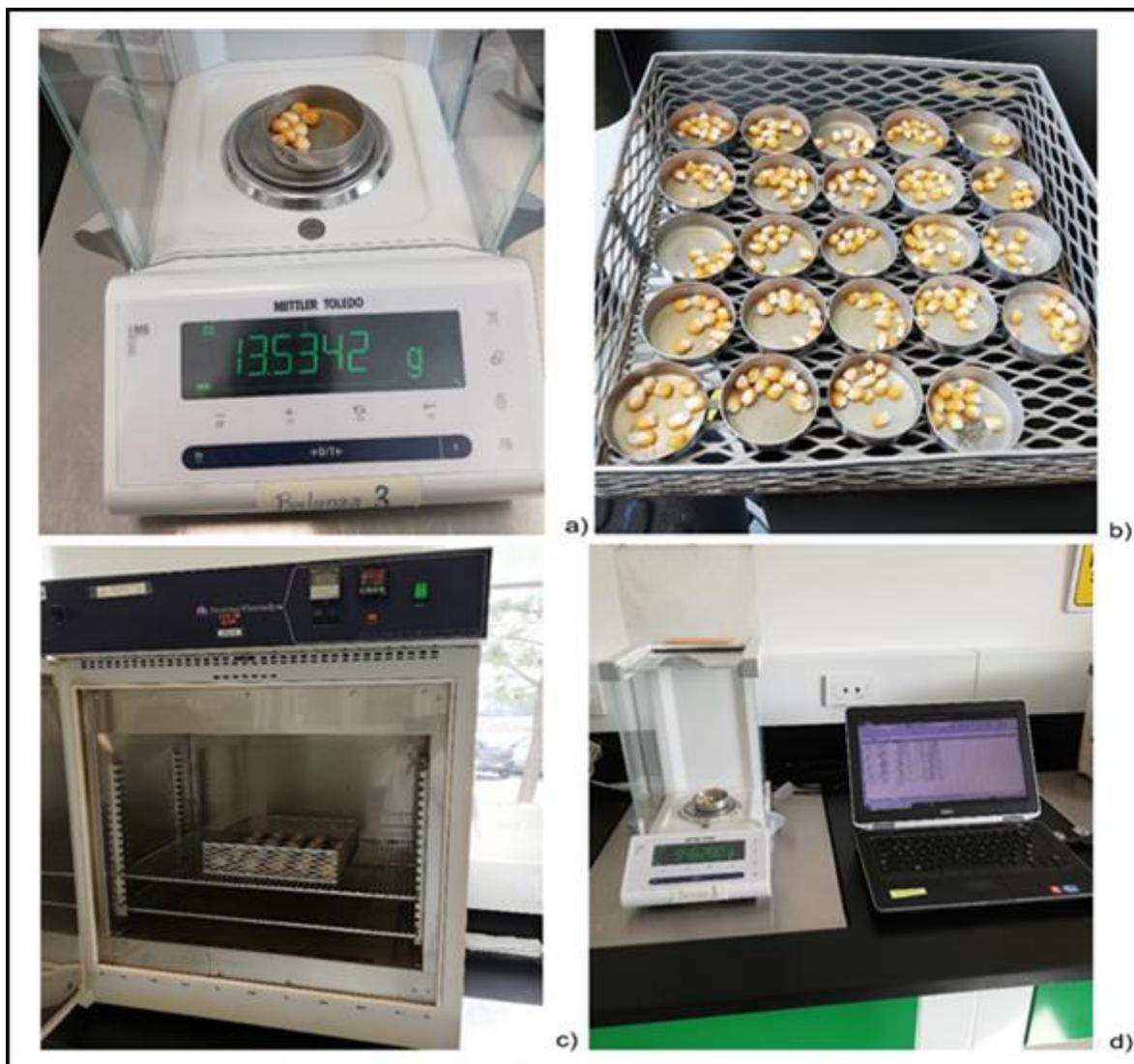
**Figura 48.** Determinación de Humedad de Semilla. a) Peso húmedo de la semilla; b) Semillas separadas por estrato; c) Secado de semillas en estufa de convección; d) Peso seco de la semilla.
