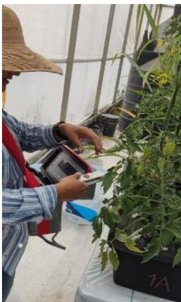
Figura 8. Medición de conductancia estomática en hojas de tomate.
