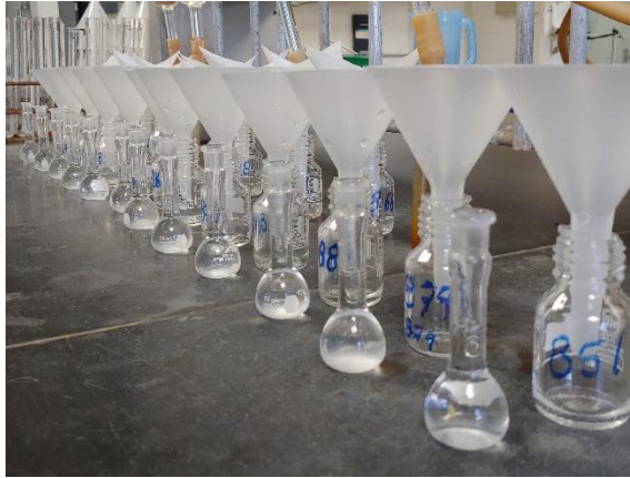
Figura 10. Aforo de la muestra a 10 mL para la determinación de cloruro.
