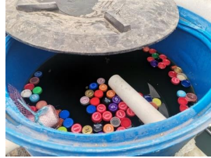
c. Biofiltro sistema familia Díaz Marín, en donde se colocaron taparrosas de refresco para generar el biofilm de bacterias fijadoras de nitrógeno
