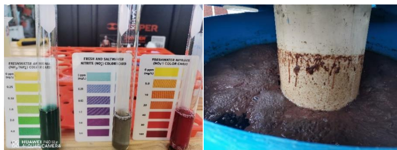
b. Medición de datos en concentraciones altas y tóxicas (amonio < 8mg/l), ya se observa por la tonalidad verde oscuro del primer tubo (izq.) por acumulación de sólidos en sedimentador (derecha).
