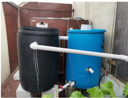
a. Sedimentador de flujo radial y biofiltro. Vista lateral.
