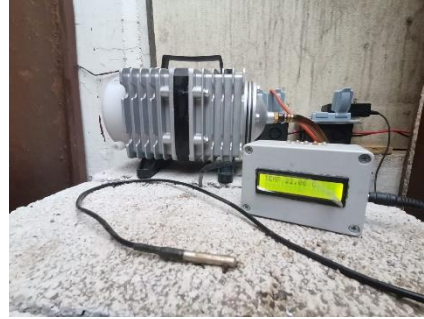
b. Compresor de aire Boyu 12 y termómetro.
