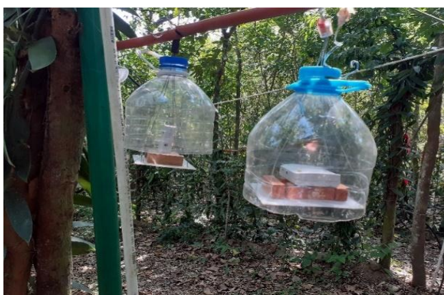
Figura 2.1. Colocación de sensores (datalogger) para registro de parámetros ambientales.
