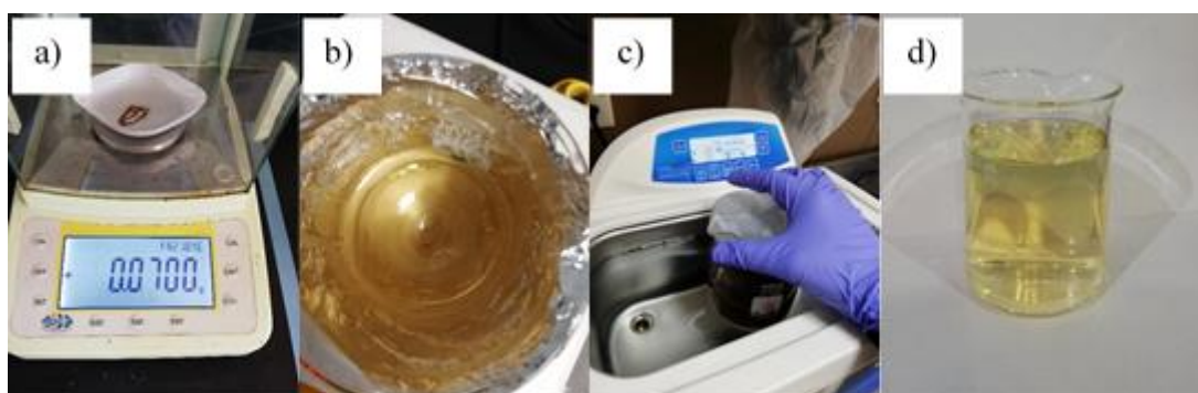
Figura 2. Extracto acuoso de pulpa de café. a) Pesado de la muestra, b) Extracción mediante calor, c) Sonicación y d) Extracto acuoso de pulpa de café.
