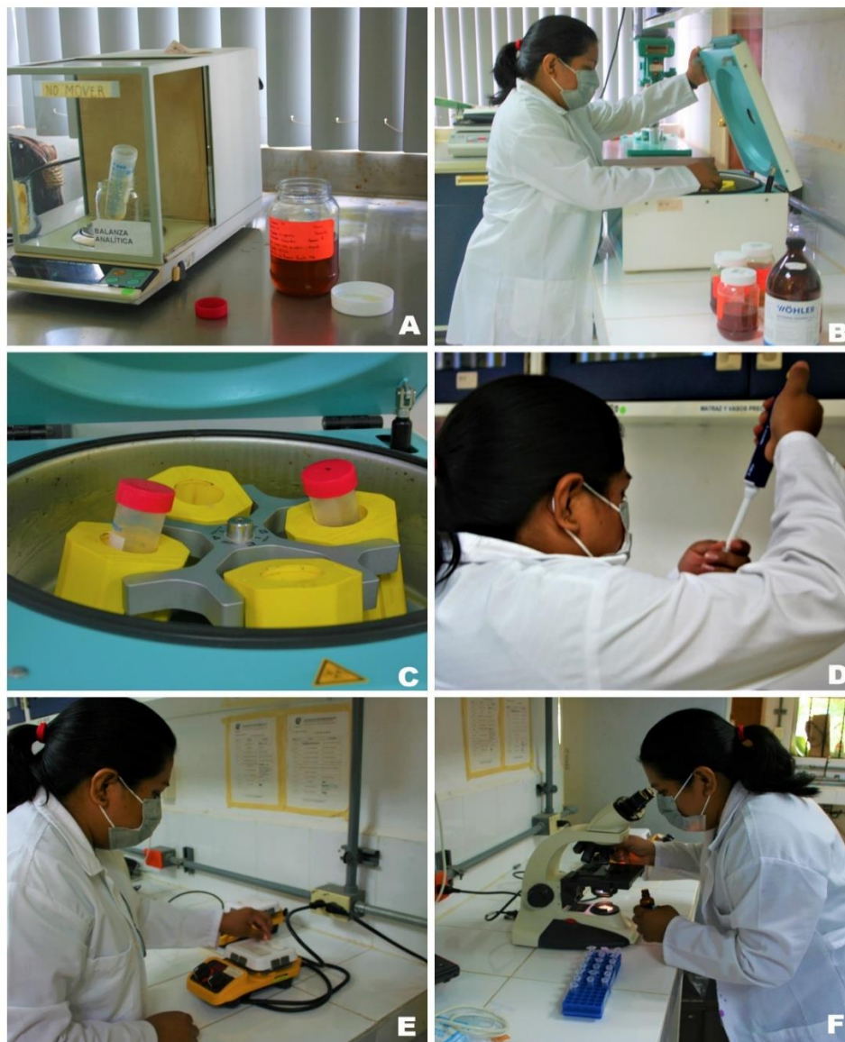
Figura 6.. Proceso de extracción del polen en las muestras de miel. A. pesado de 10 g de miel en un tubo cónico de 50 ml para su dilución en 20 ml de agua destilada, B. y C. extracción del sedimento polínico por centrifugación de la solución (10 g de miel y 20 ml de agua destilada) a 3000 rpm por 10 minutos, D. traspaso del sedimento polínico a microtubos de 1.5 ml y E. secado del sedimento polínico en portaobjetos mediante una placa de calentamiento a 40 °C, F. Identificación de las muestras polínicas mediante observación al microscopio con los objetivos 40x y 100x.
