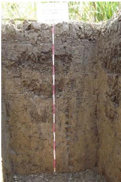
Figura 6. Perfil del suelo Vertisol bajo condiciones de trópico húmedo, presente en el campo experimental del Colegio de Postgraduados, Campus Tabasco, lugar donde se extrajo el suelo de los primeros 30 cm para el experimento. Foto: Luis Alberto Cerón Hernández.
