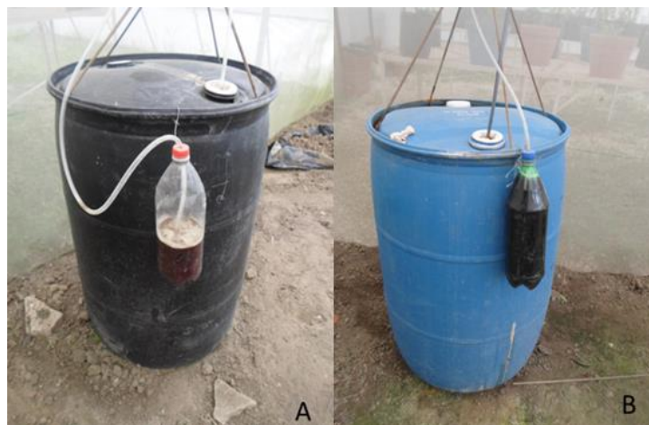
Figura 3. Vista final de los biodigestores: A) Guano de murciélago y B) Estiércol bovino.
