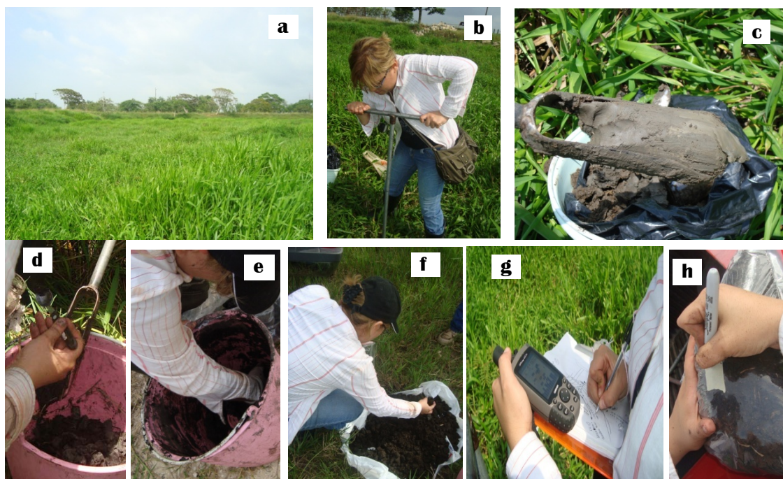
Figura 2. Proceso de toma de muestras: a) selección del sitio, b) obtención de las submuestras, c) suelo gleysol, d) toma de muestra para HTP, e) y f) homogeneización de las muestras para análisis de fertilidad, g) georeferenciación de la zona de estudio y h) etiquetado de las muestras.
