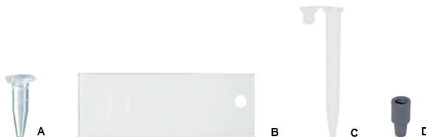
Figura 4. Liberadores utilizados para determinar la volatilidad de los compuestos. A) tubos de microcentrífuga, B) bolsas de polietileno, C) tubos de microcentrífuga (atrayerente alimenticio) y D) septos de caucho (feromona de agregación).
